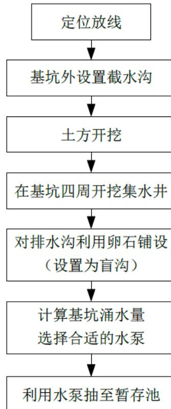
图 5.1-3 降水施工流程图
