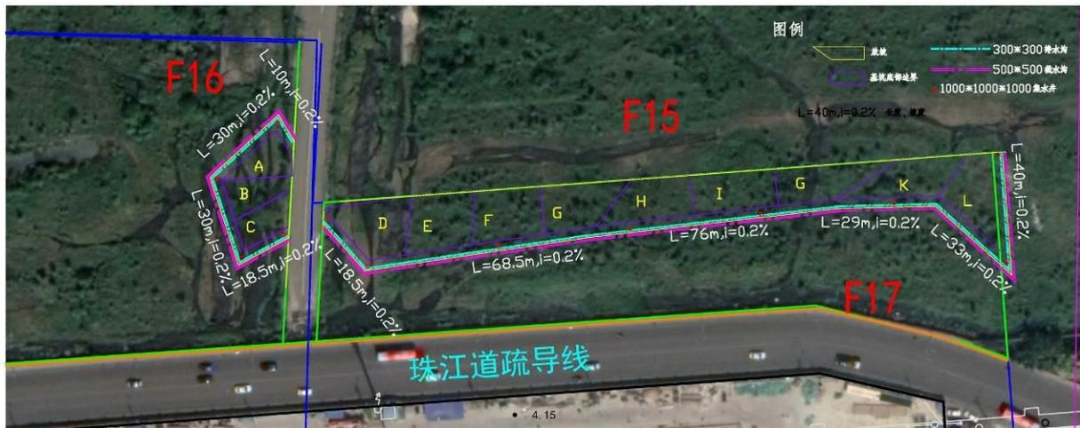
图 5.1-2 基坑降水平面图
